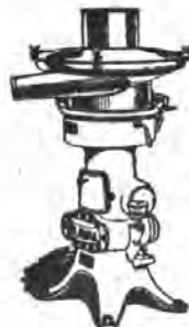
De Laval Clarifier
